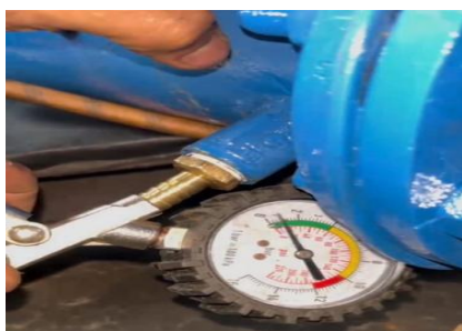
Gambar 5. Pengujian pneumatik pada sisi shell
