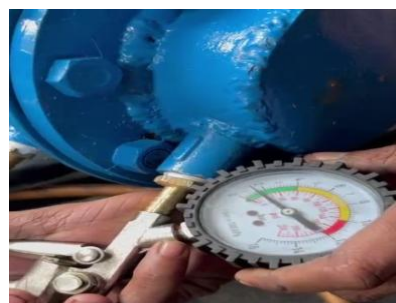
Gambar 6. Pengujian pneumatik pada sisi tube
