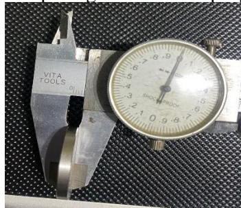
Gambar 4.2 Pengukuran ketebalan plat kalibrasi
