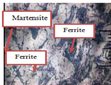
(a) FCAW V 70A 200x Daerah Las
