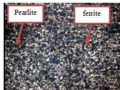
(b). FCAW V 70A 100x Daerah HAZ
