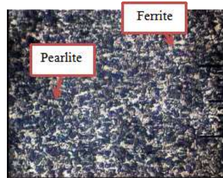
(b). FCAW X 90A 100x Daerah HAZ
