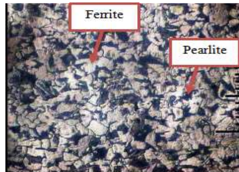
(c). FCAW X 90A 100 x Daerah Base Metal
